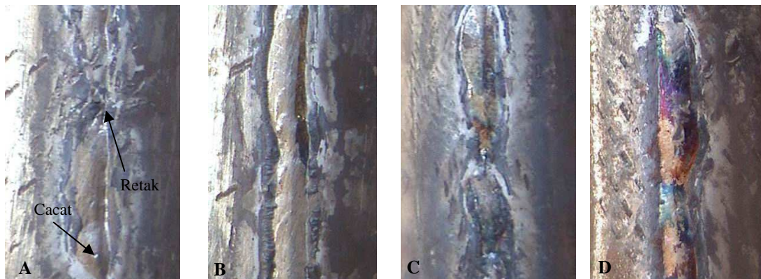
Gambar 7. Penampang benda uji setelah uji face bend dengan pemanasan awal elektroda : A) Tanpa pemanasan, B) Pemanasan 100 C , C) Pemanasan 150 C, D) Pemanasan 200 C
