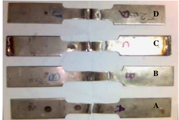
Gambar 5. Gambar spesimen uji setelah diuji tarik pada perlakuan elektroda : A) Tanpa pemanasan, B) Pemanasan 100 C, C) Pemanasan 150 C dan D) Pemanasan 200 C
